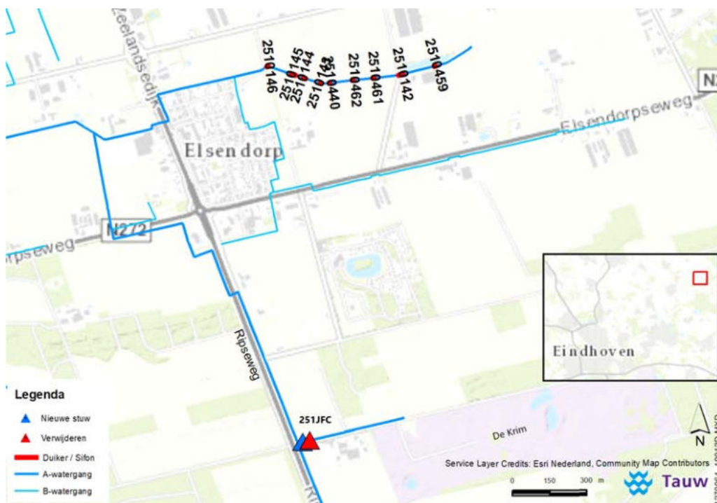
Figuur 2.2 Voorgenomen werkzaamheden
