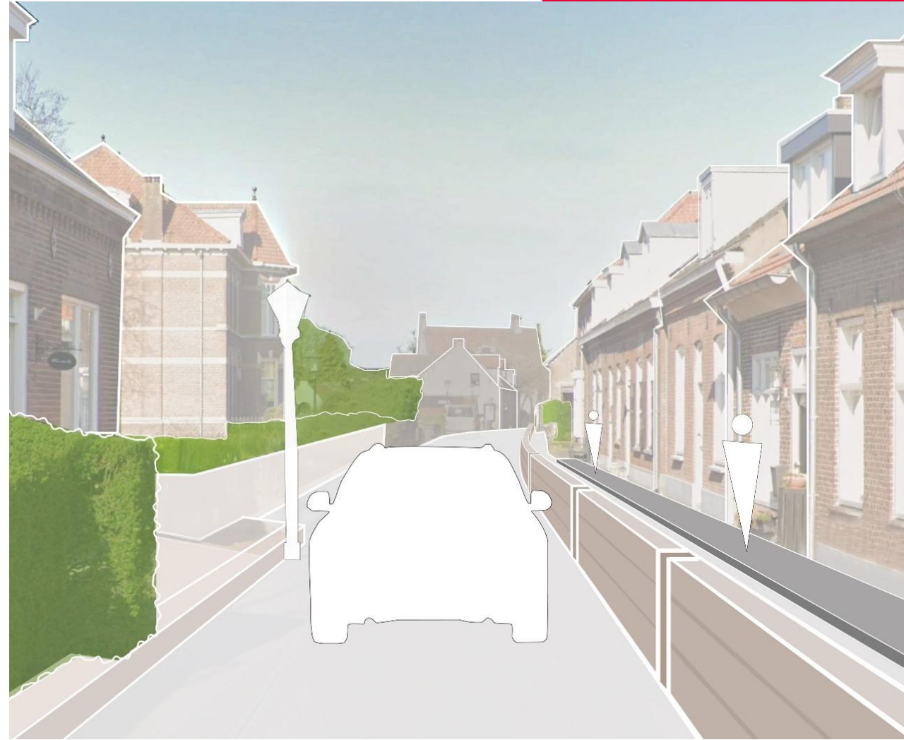
Hoogwatersituatie – kering opgebouwd
