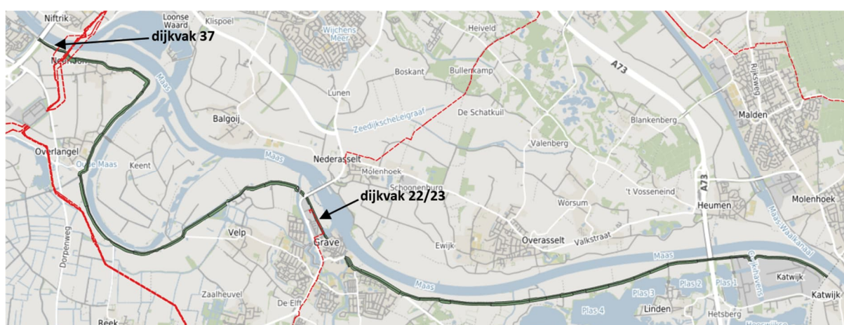
Figuur 6-9 Aardgastransportleidingen die de dijk kruisen (dijkvak 37) en parallel aan de dijk lopen (dijkvak 22/23)
