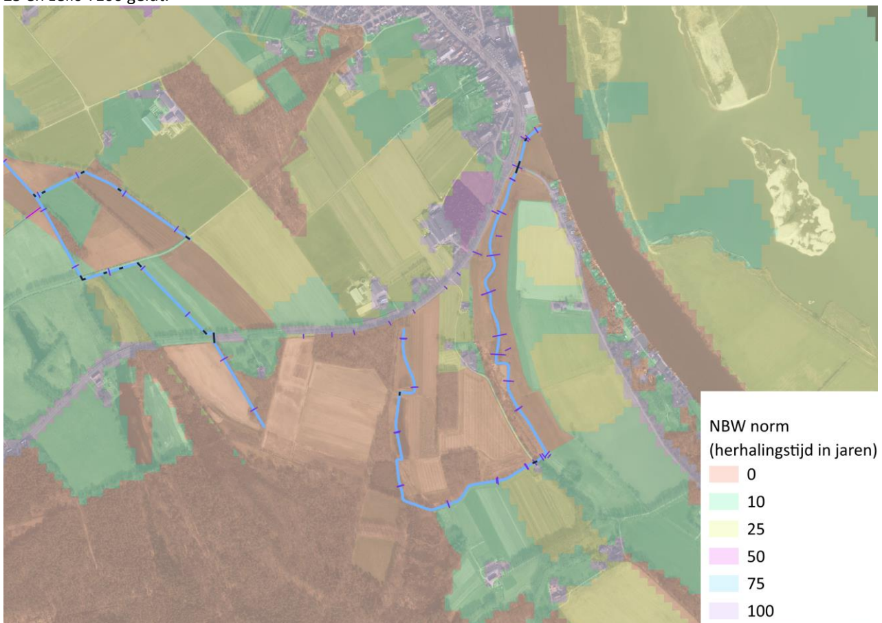
Figuur 4: De NBW-normeringskaart van het stroomgebied van de Campagnebeek. Toont per pixel bij welke verschillende herhalingsstijd een inundatie mag plaatsvinden. De normeringen zijn gebaseerd op landgebruikstype.
