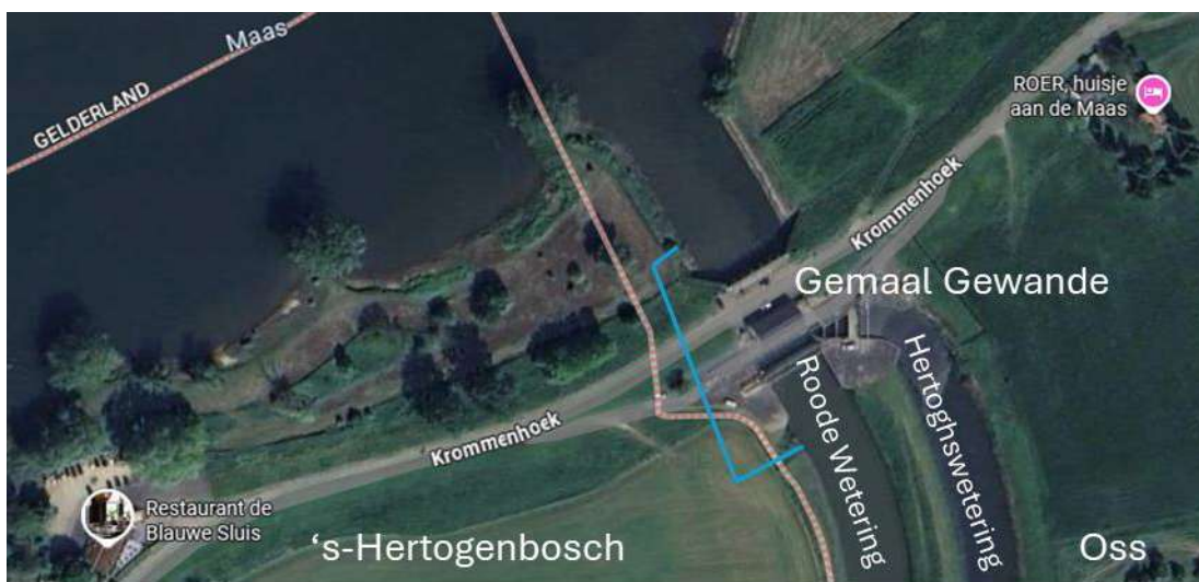
Figuur 2-1: overzicht locatie gemaal Gewande met de locatie van de vispassage als blauwe lijn aangeduid
