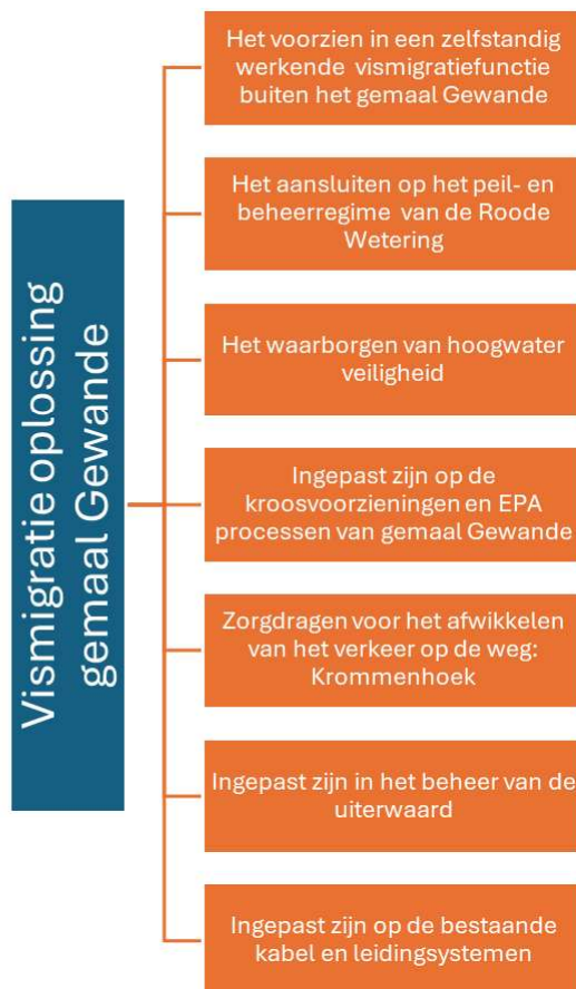
Figuur 2-2: functieboom Gewande. Dit is de functieboom op basis waarvan het ontwerp is opgesteld. Voor ht UAV-gc contract zal de functieboom specifiekere worden gemaakt voor het contract
