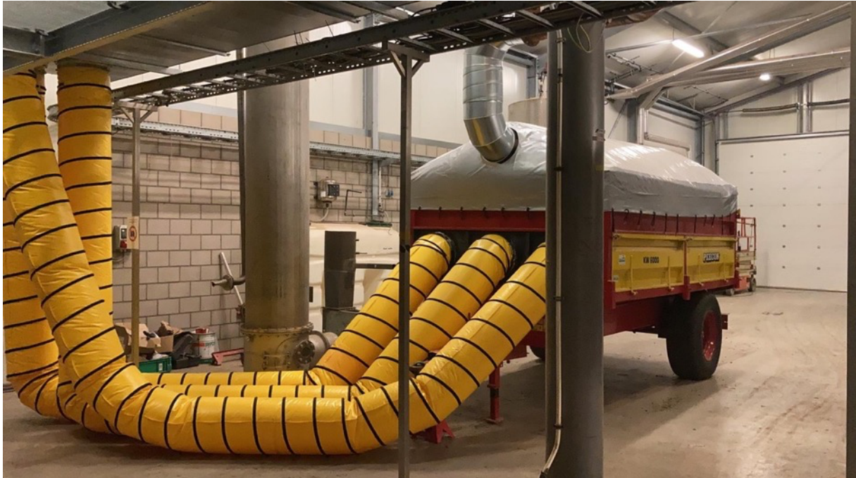
Figuur 2 - Mobiele droogcontainer met duurzaam opgewerkte warmte
