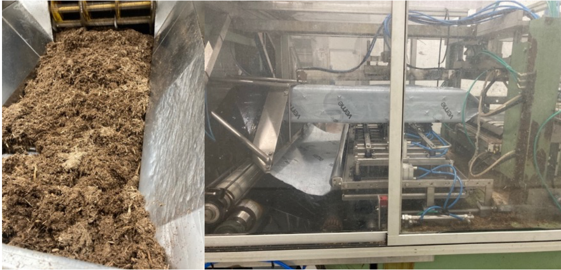
Figuur 9 - Het lisdodde substraat in de voorraadhoopper en het produceren van de pakketten
