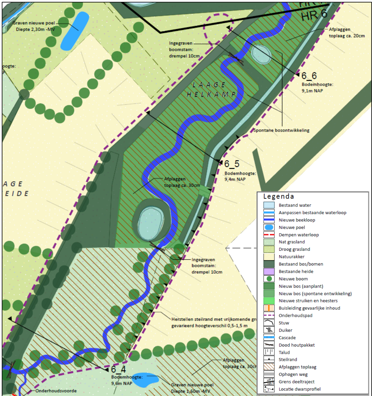
Figuur 4.9: DO Hooge Raam traject 6 – Maatregelen rondom nieuwe meander: bestaande houtwal tot einde traject 6
