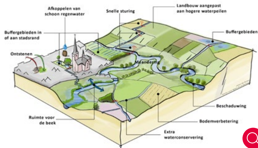
Figuur 2.7: Enkele maatregelen die bijdragen aan een klimaatadaptieve inrichting van het watersysteem
