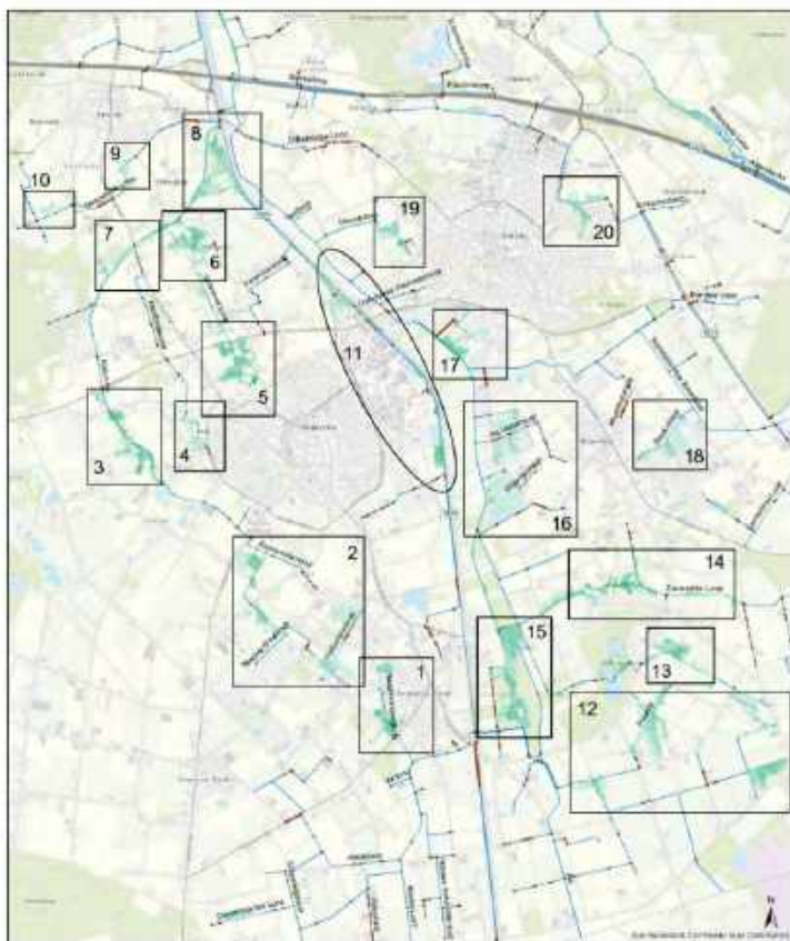
Figuur 4-13. Berekende locaties met inundatie in de huidige situatie ten gevolge van de neerslagpiek uit 2016
