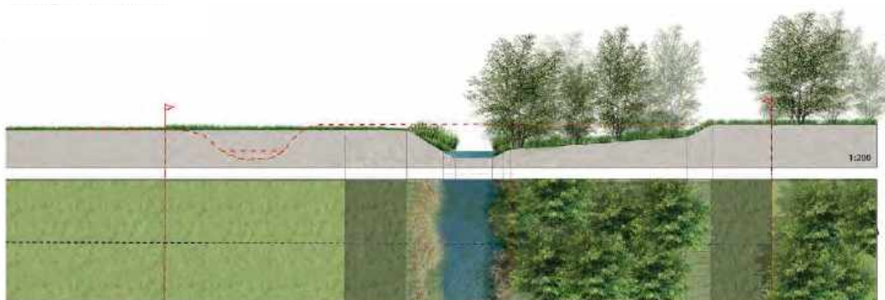
Figuur 5-3. Dwarsdoorsnede (boven) en bovenaanzicht (beneden) van het asymmetrisch accolade profiel.
