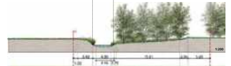
Profiel voorkeursvariant bij Strakriet (profiel 201001P0370) Minimaal meanderende beek met rechts een accoladeprofiel (flauwe oever). Dit profiel is realiseerbaar binnen eigendom Waterschap/Staatsbosbeheer
