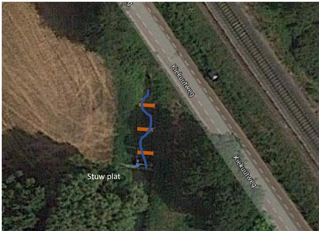
Figuur 9.2. Principeschets van een vispassage benedenstrooms van de stuw
